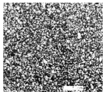
0,6 μm, 10 % Co, 1,35% Cr_3C_2
